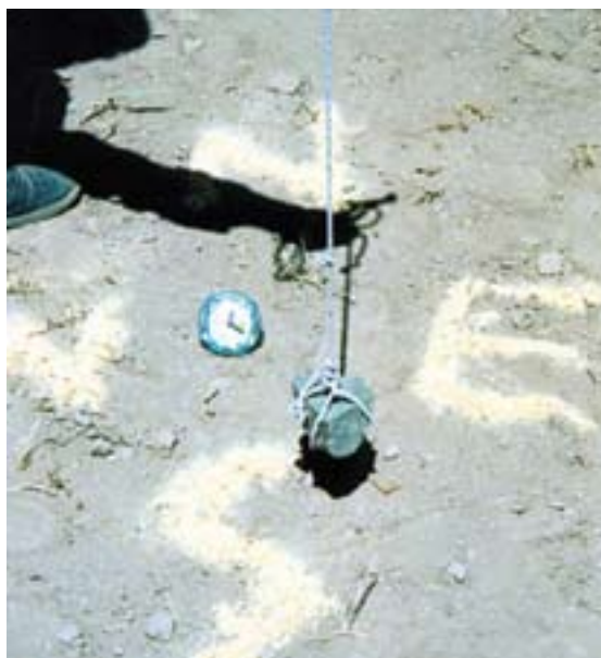
Фото 11 - Определение направления на юг с использованием веревки с отвесом
