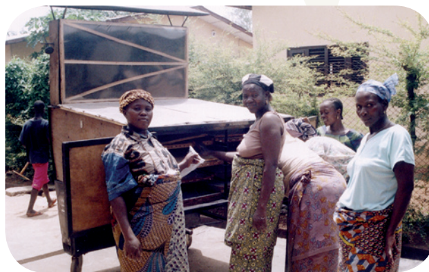
Modèle de séchoir « solaire-gaz » Maxicoq en fonctionnement au Sud Bénin
