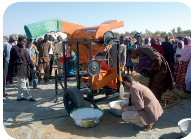
un exemplaire d'une batteuse à mil en cours de vulgarisation au Niger
