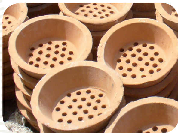
Des céramiques pour équiper des foyers Sewa pour la cuisson.
